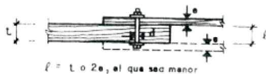
Fig. 10.3.2.5. Unión emperrada sometida a cizallamiento simple.
