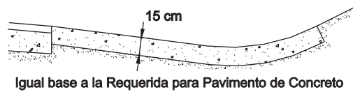
CUNETA DE CONCRETO
